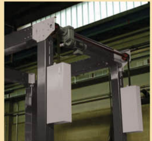
SISTEMA DE CONTRAPESOS PARA OPERACIÓN MÁS SUAVE, SEGURA Y SIN VIBRACIONES
