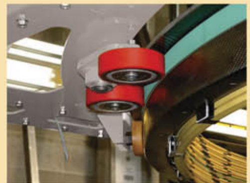
RUEDAS DE GUÍA VERTICALES Y HORIZONTALES, AUTO-ALINEANTES. RUEDAS GUÍAS DE POLIURETANO SIN MANTENIMIENTO
